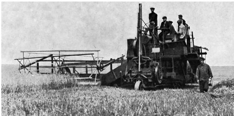
Перший у світі самохідний зернозбиральний комбайн фірми Holt (США) під час випробовувань на Якимівському відділенні Бюро по сільськогосподарській механіці. 1914 р.
